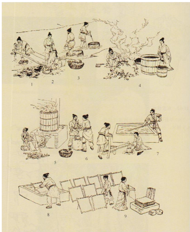
图 6-8 汉代造麻纸工艺流程
