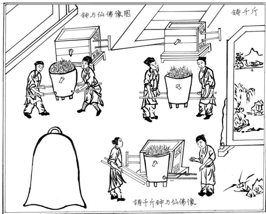
图 3-11 《天工开物》中描绘的大钟和小件器的铸造
