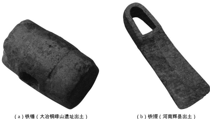
图 3-3 战国时期氧化气氛下柔化处理的铸铁
