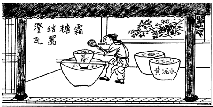
图 10-2 《天工开物》所绘瓦器溜——黄泥水使蔗糖脱色
