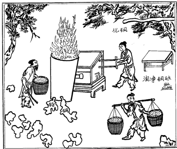
图 2-11 铜砂冶炼（录自《天工开物》）
